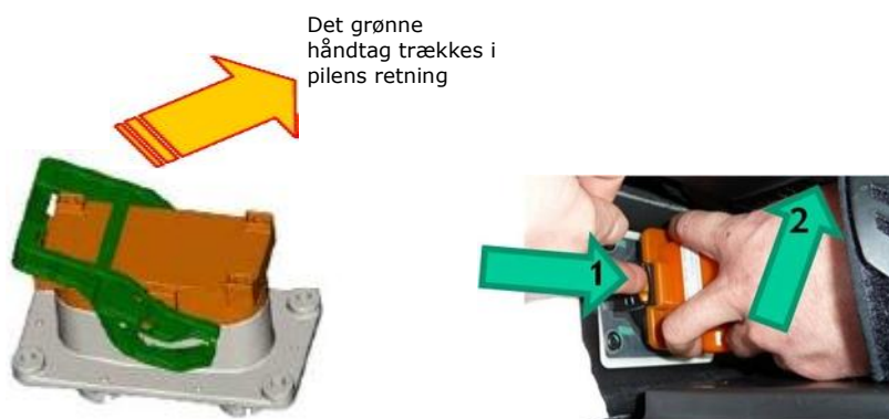
Et eksempel på udtagning af sikkerhedsafbryderen i Renault til venstre og Opel til højre.
