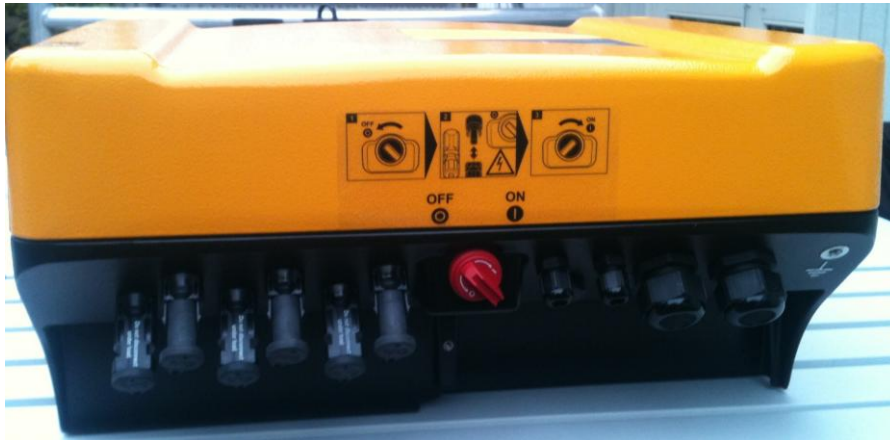
Et eksempel på en sikkerhedsafbryder på en inverter.
