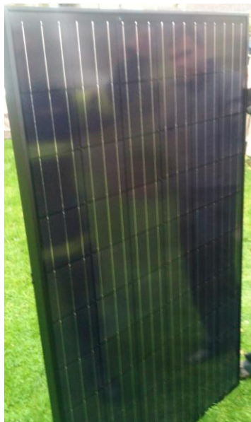
Et eksempel på et typisk solcellepanel. Når solen skinner producerer dette ene panel ca. 200 Watt (26 Volt ved 8 Ampere).
