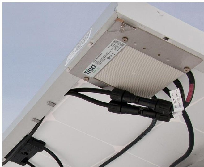
Et eksempel på et afbryderrelæ som er indbygget i panelet.
