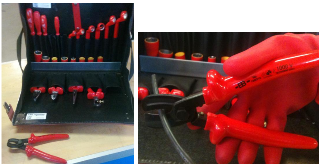
Et eksempel på L-AUS værktøj med de særlige stafferinger. Kabler skal klippes enkeltvis.
