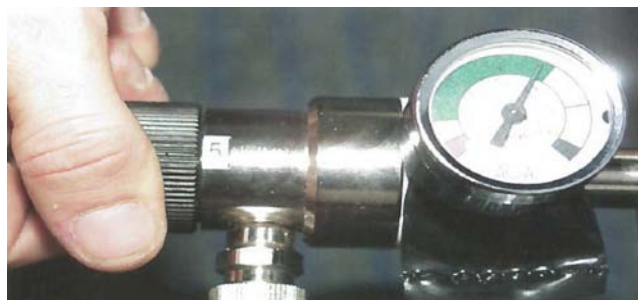
Reduktionsventil på iltflaske. Her indstilles doseringen.
